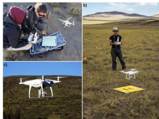
**Figura 1.** Equipo utilizado para realizar los vuelos experimentales. a) El dron consta de dos elementos principales, la aeronave y el control remoto. Además, es necesario utilizar una *tablet* para configurar los planes de vuelo. b) El dron es despegado desde una base firme que evita el contacto con la vegetación o rocas y el polvo en suspensión que provocan los motores en despegue y aterrizaje. c) DJI Phantom 4 Advance en vuelo. *Fotos: Pablo Moreno, Natalia Schroeder, Antonella Panebianco*
